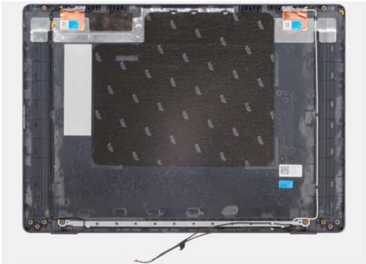
Afbeelding 96. Removing the display back-cover assembly
