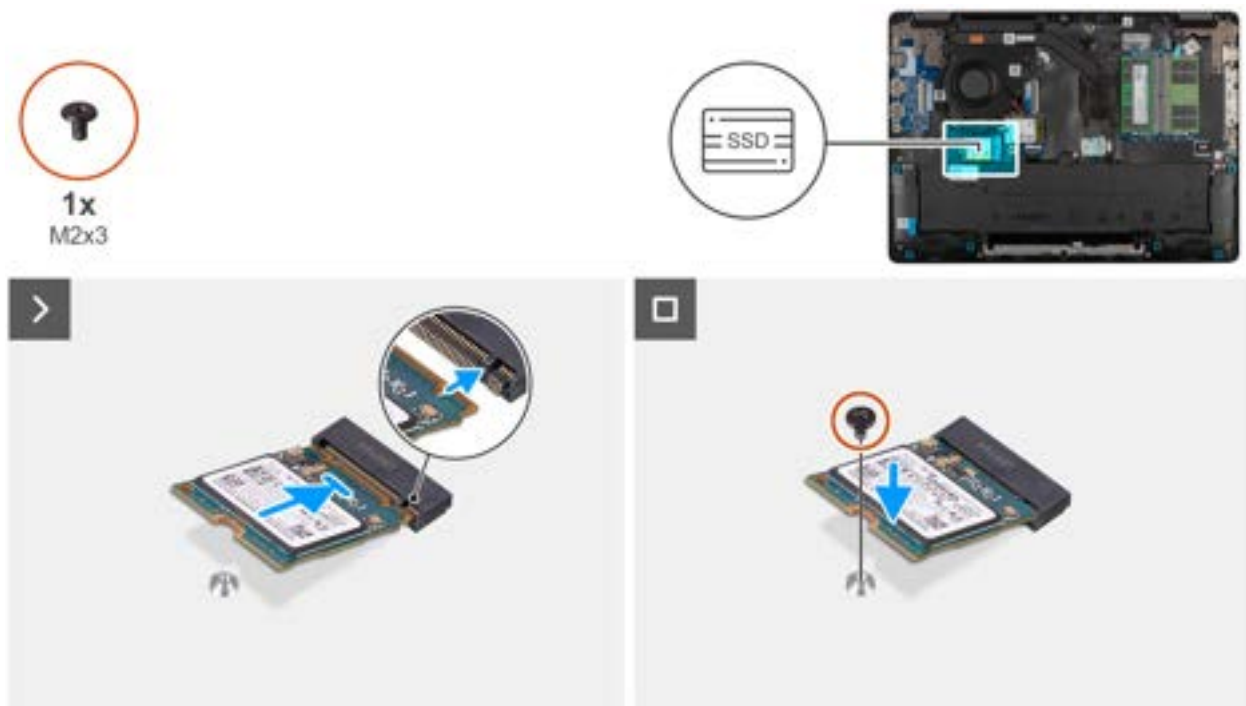
Afbeelding 24. Installing the SSD
