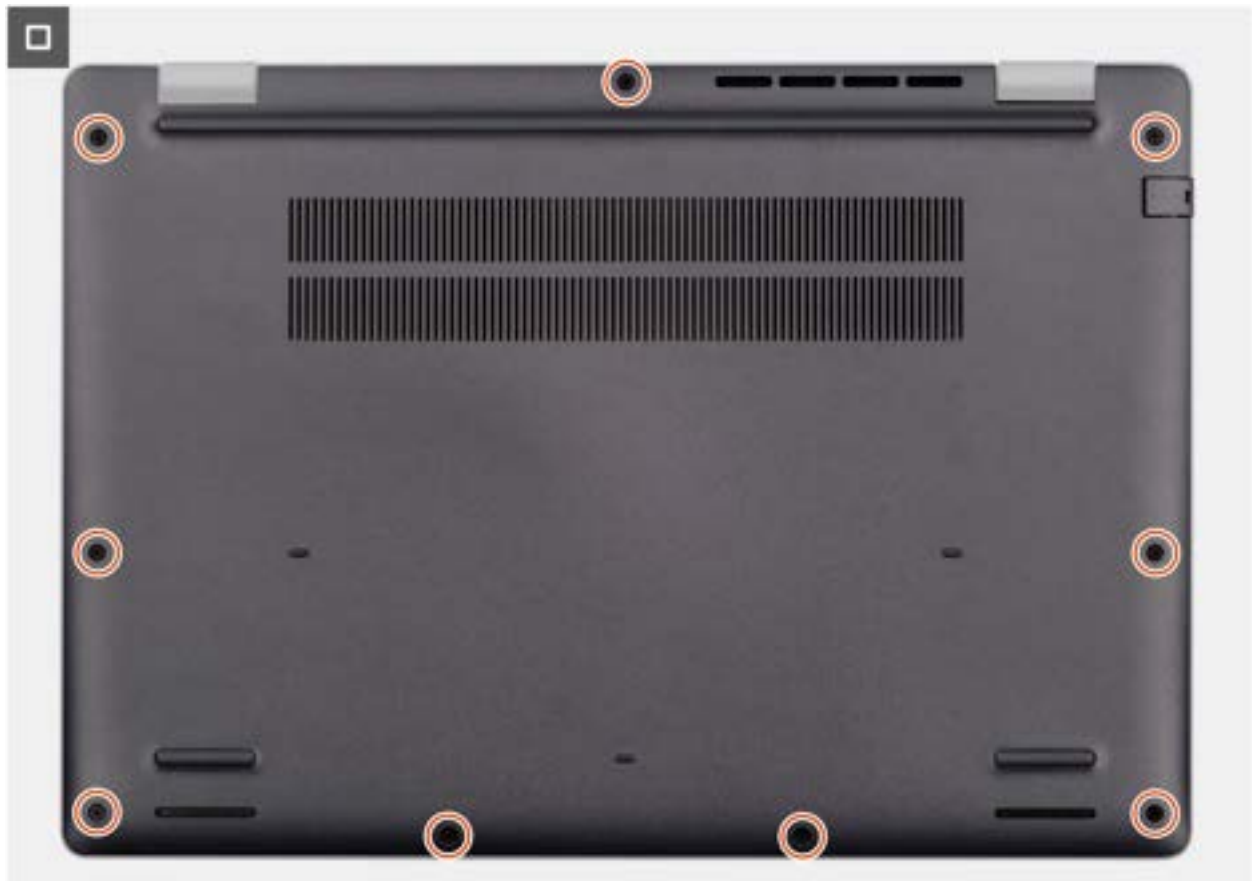
Afbeelding 16. Installing the base cover
