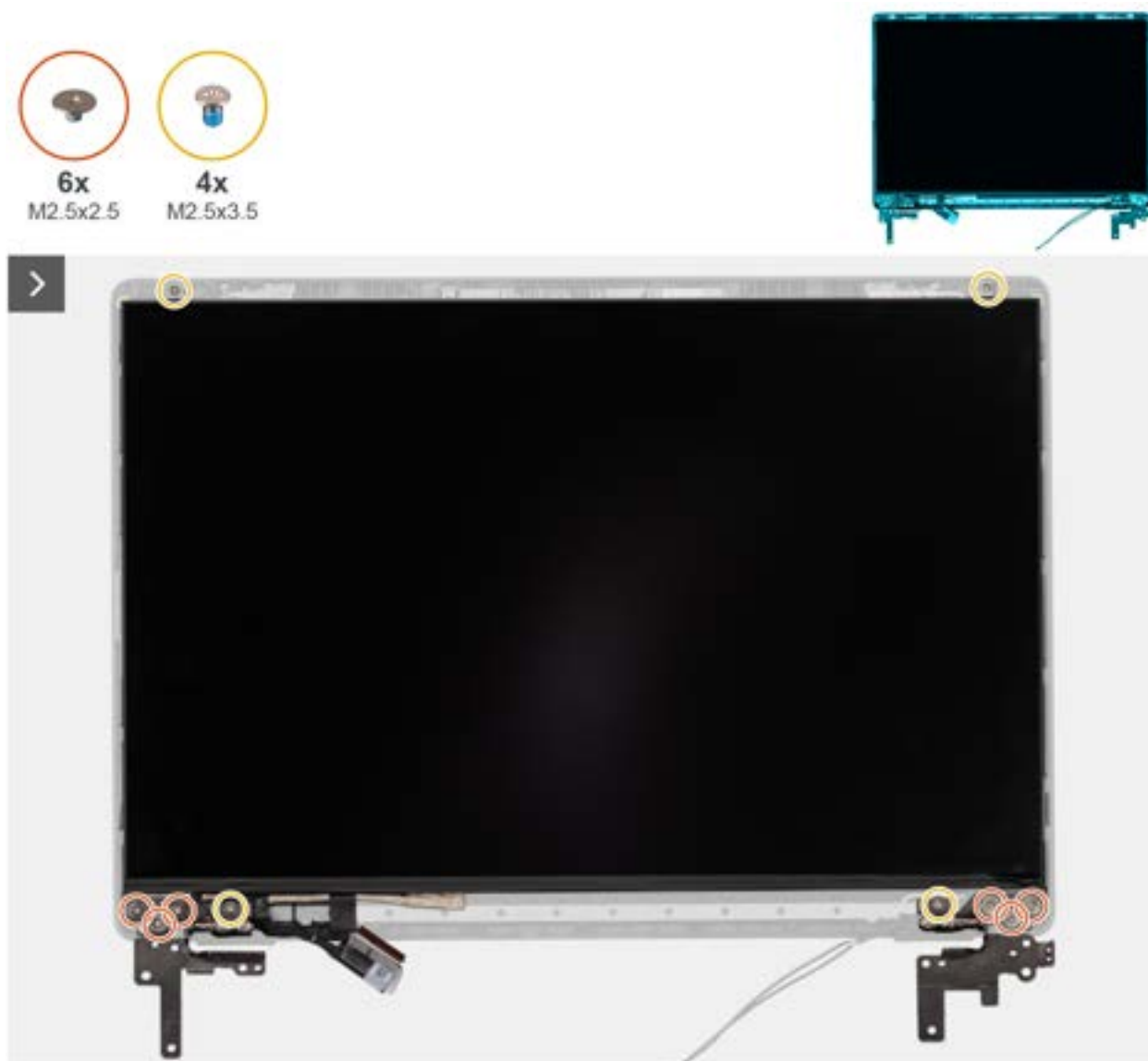
Afbeelding 84. Removing the display-panel assembly
