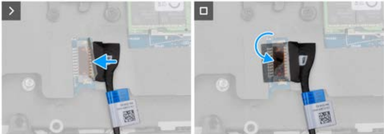
Afbeelding 14. Connecting the battery cable
