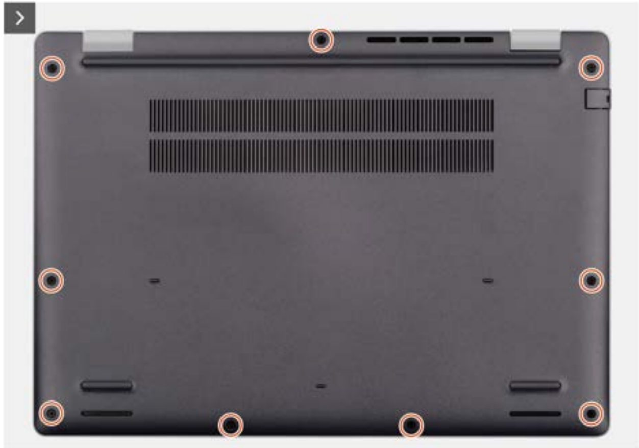
Afbeelding 11. Removing the base cover
