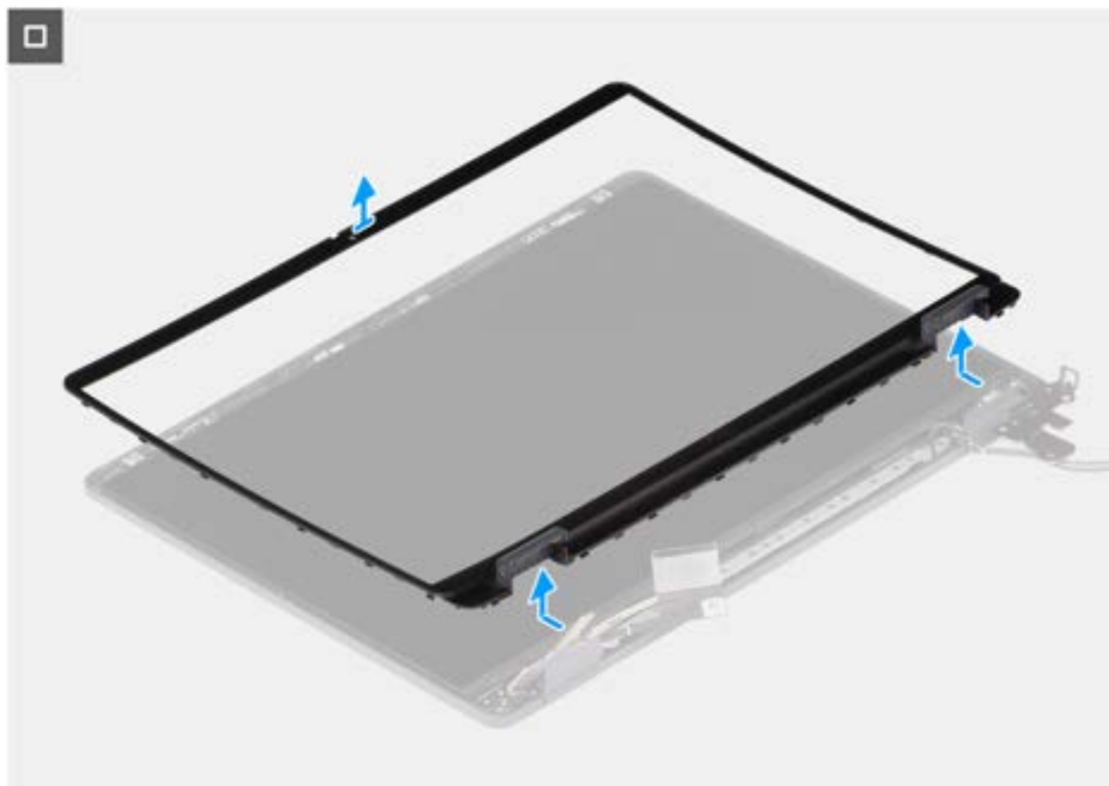
Afbeelding 81. Removing the display bezel
