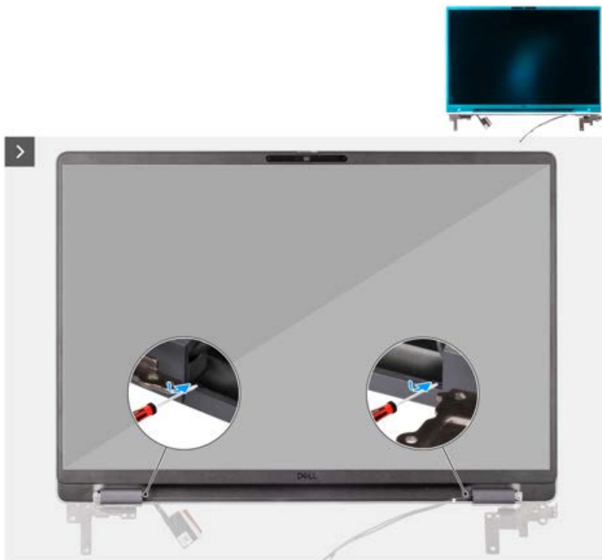
Afbeelding 77. Removing the display bezel
