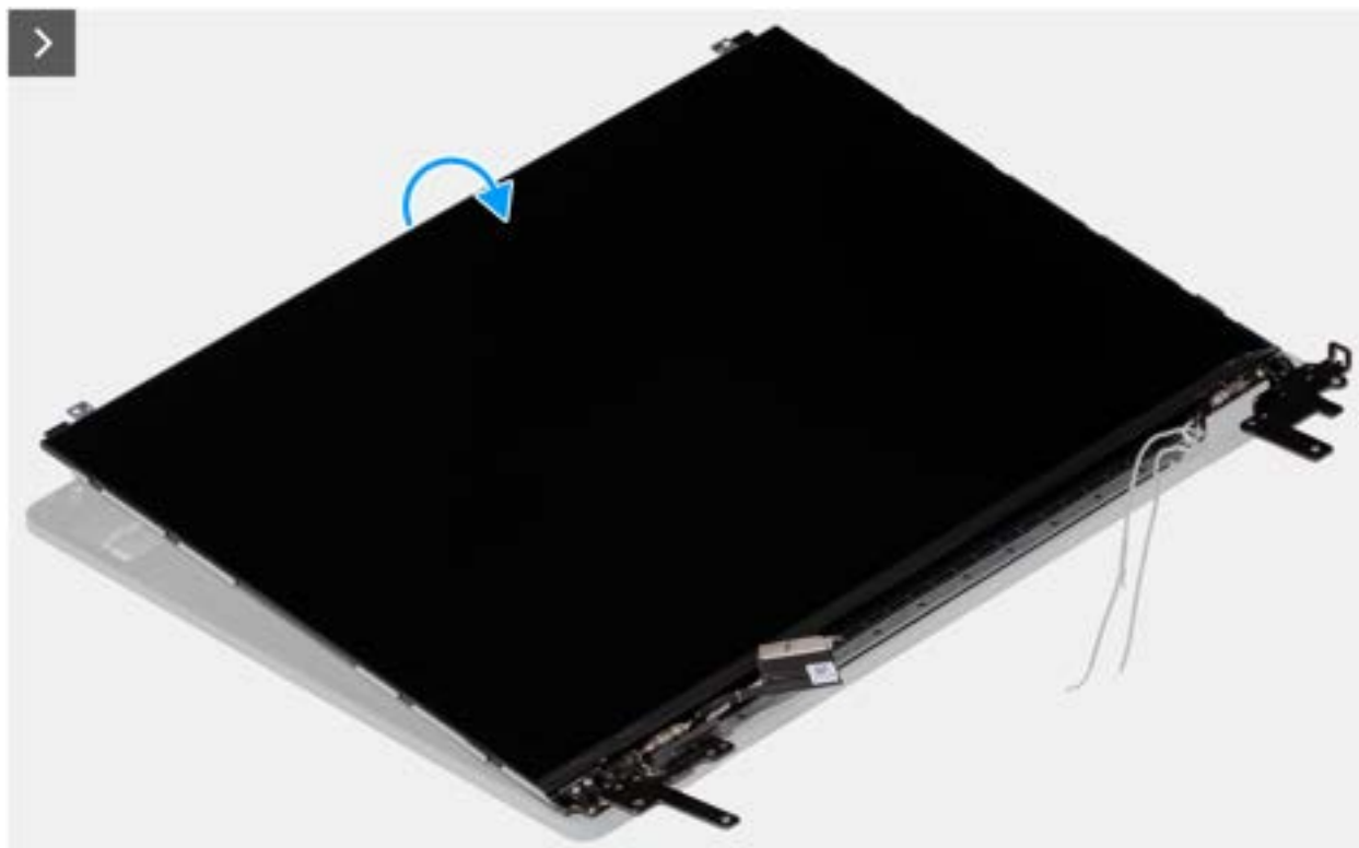
Afbeelding 85. Removing the display-panel assembly
