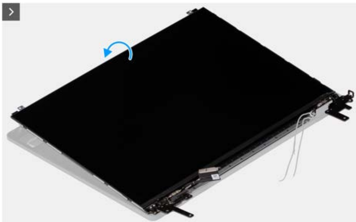
Afbeelding 90. Installing the display-panel assembly
