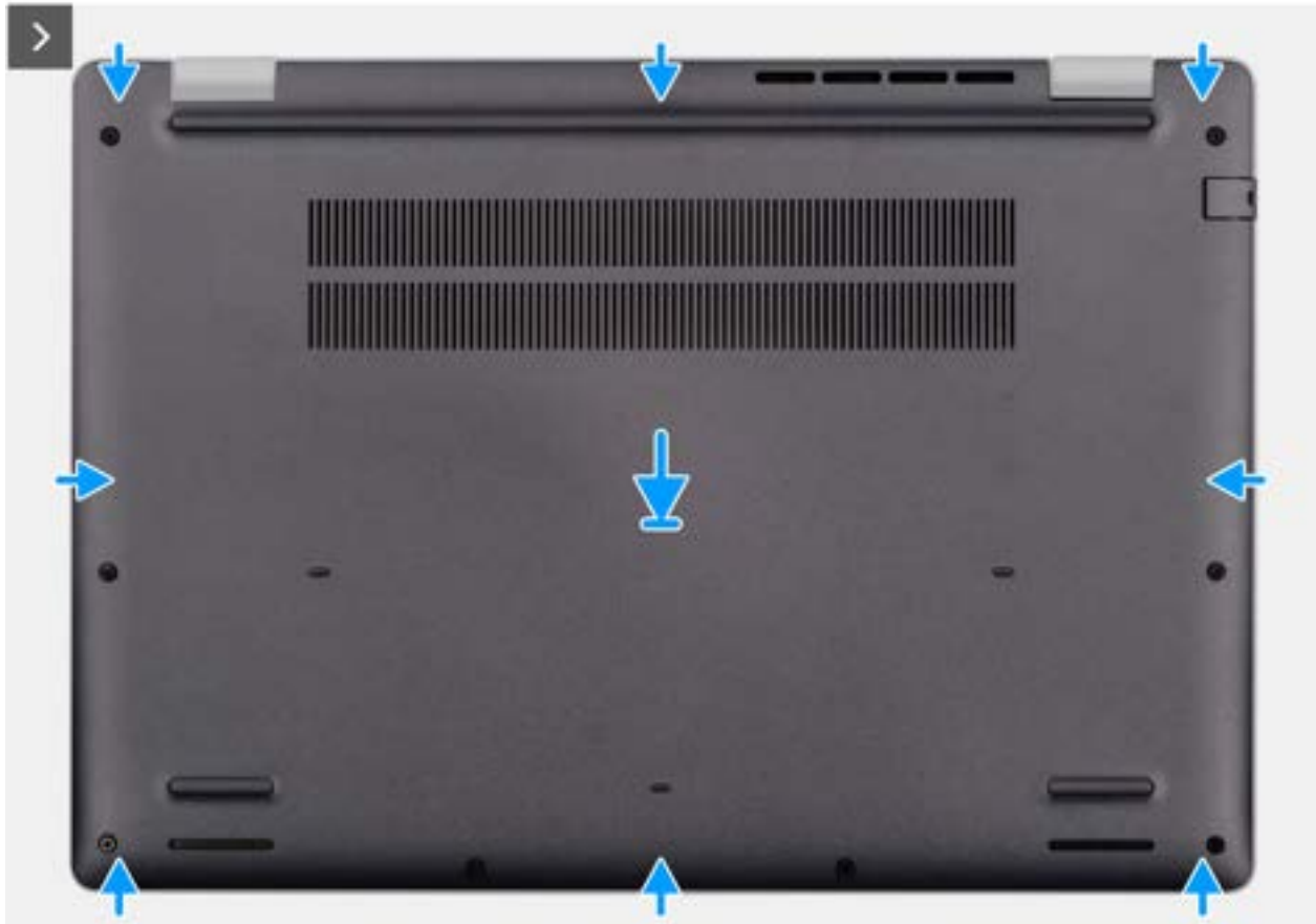
Afbeelding 15. Installing the base cover
