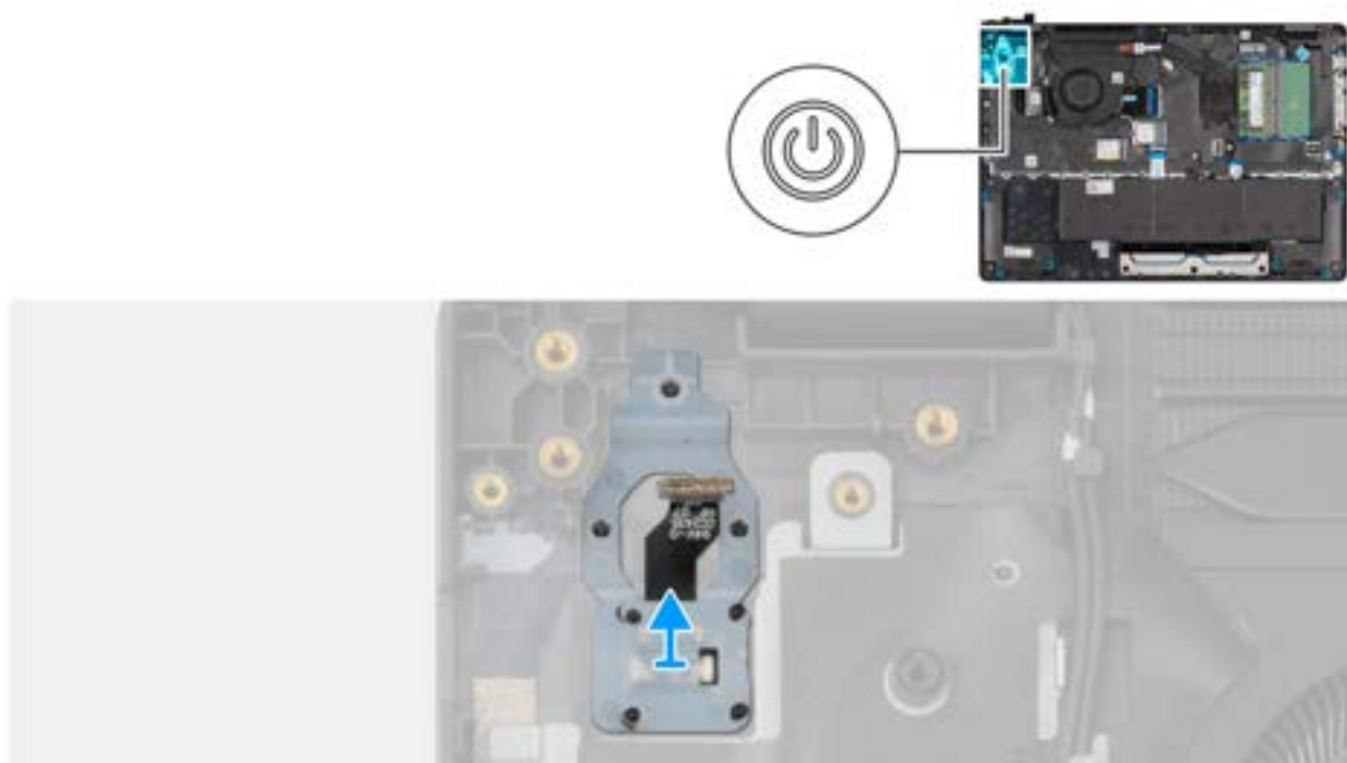
Afbeelding 44. Removing the power button with fingerprint reader
