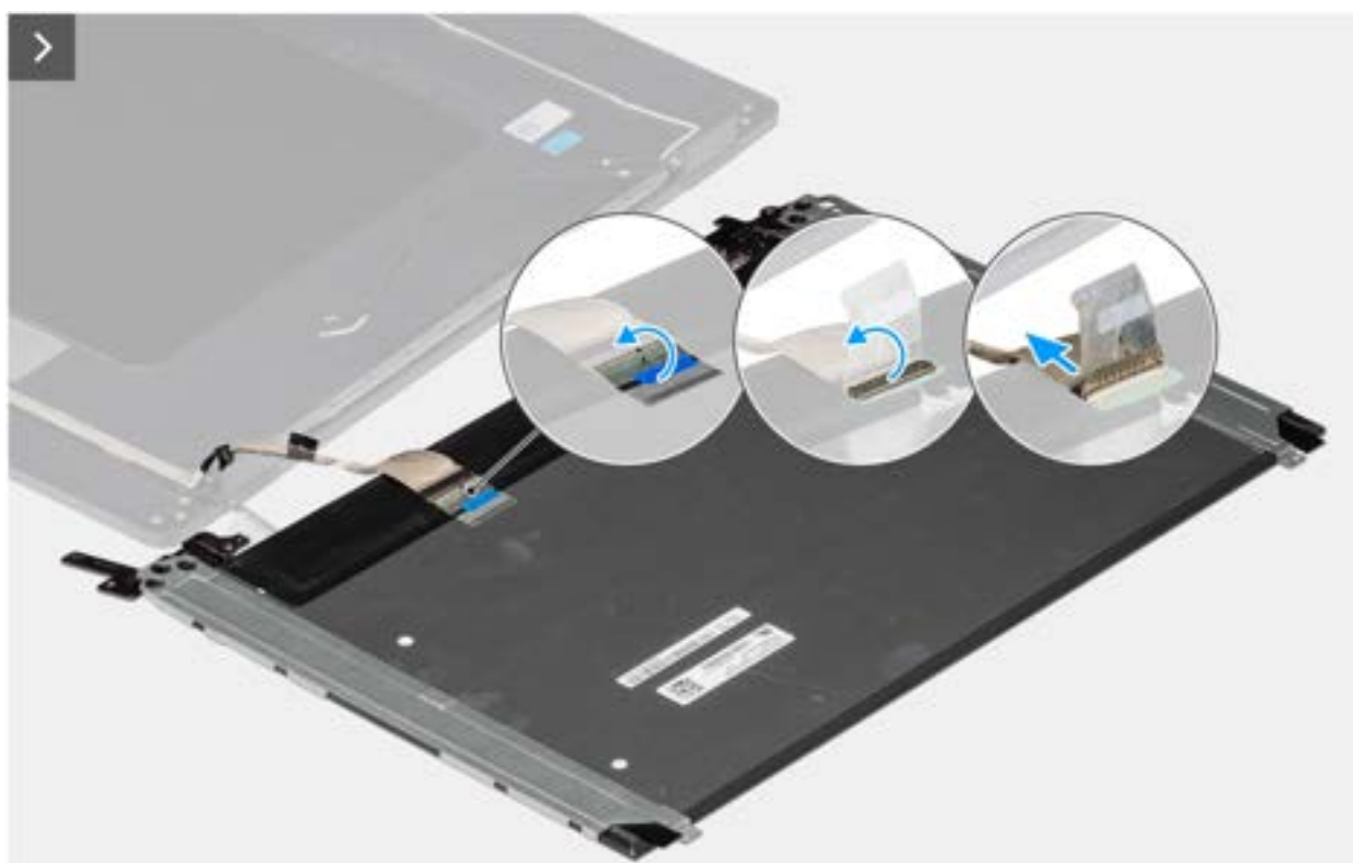
Afbeelding 86. Removing the display-panel assembly
