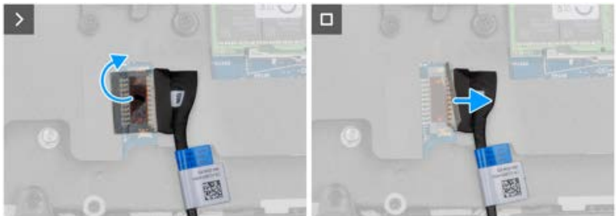
Afbeelding 13. Disconnecting the battery cable
