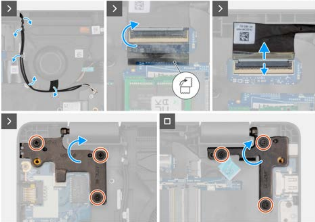
Afbeelding 72. Removing the display assembly
