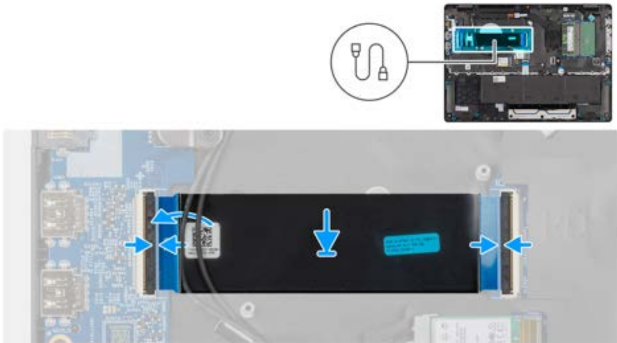
Afbeelding 43. Installing the I/O-board FPC cable
