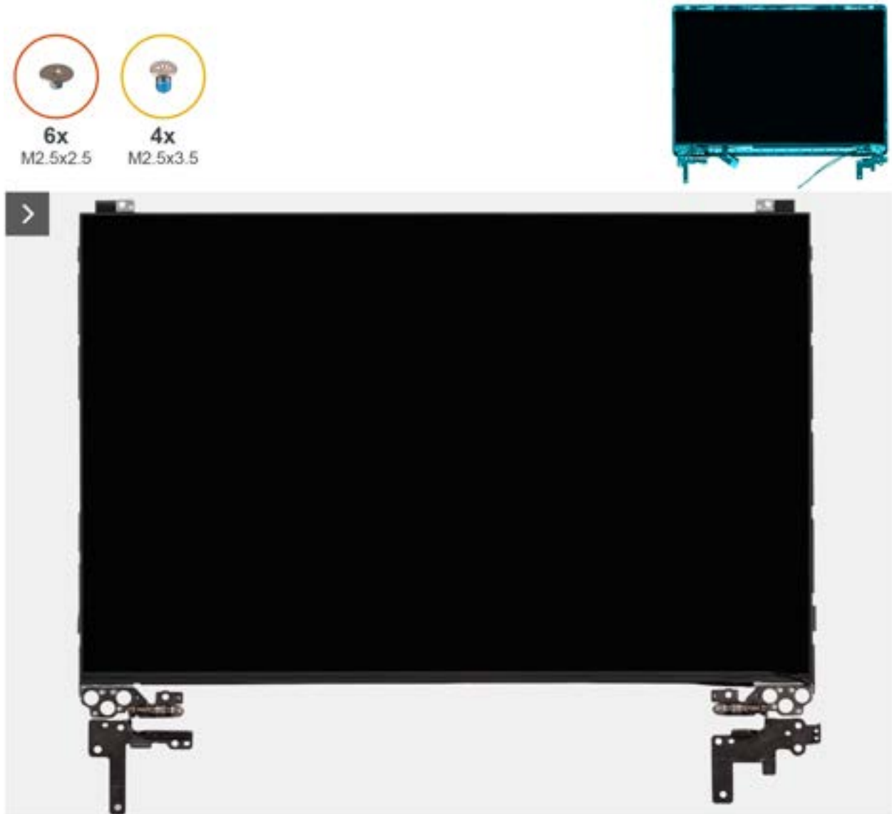
Afbeelding 88. Installing the display-panel assembly
