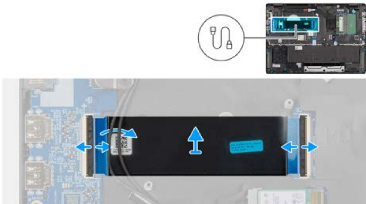
Afbeelding 42. Removing the I/O-board FPC cable
