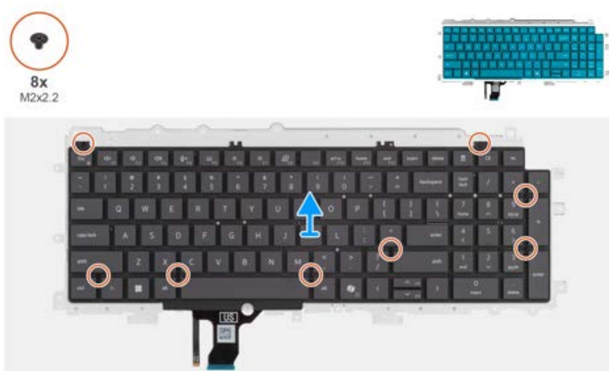
Afbeelding 66. Removing the keyboard support plate
