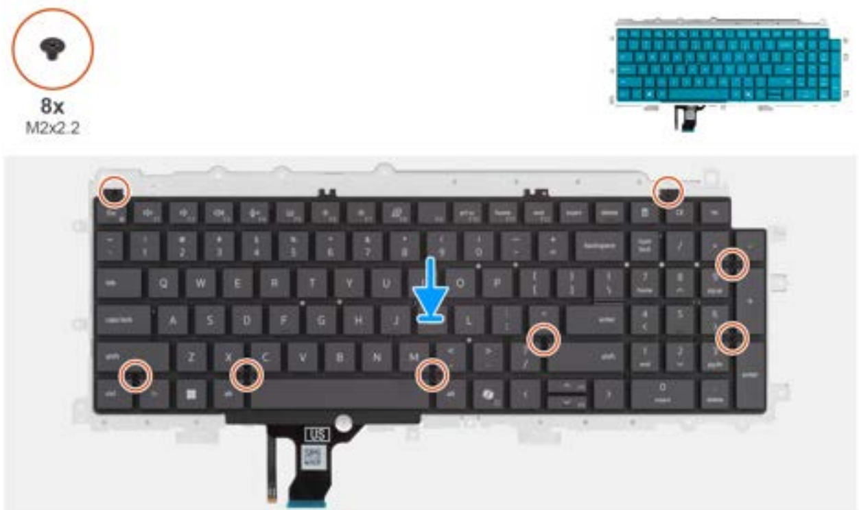
Afbeelding 69. Installing the keyboard support plate
