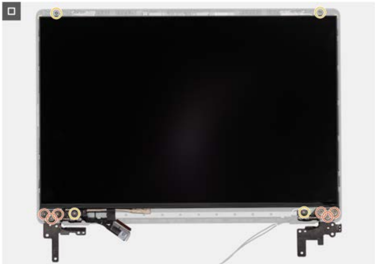
Afbeelding 91. Installing the display-panel assembly
