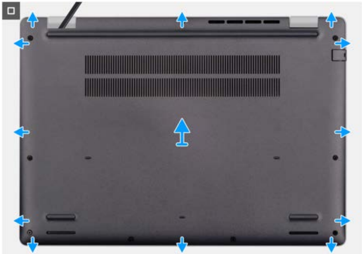
Afbeelding 12. Removing the base cover
