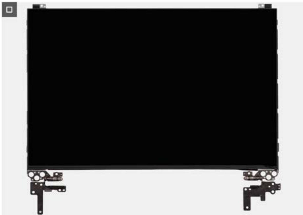
Afbeelding 87. Removing the display-panel assembly
