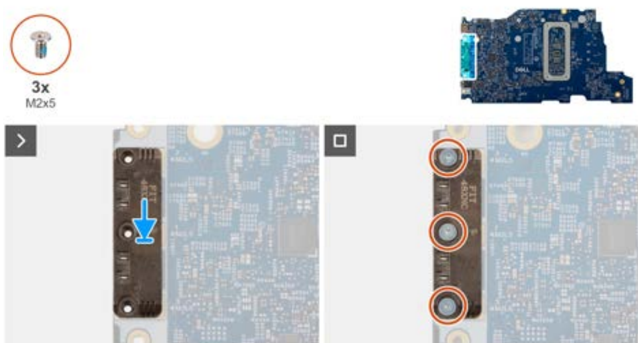
Afbeelding 59. Installing the USB Type-C module
