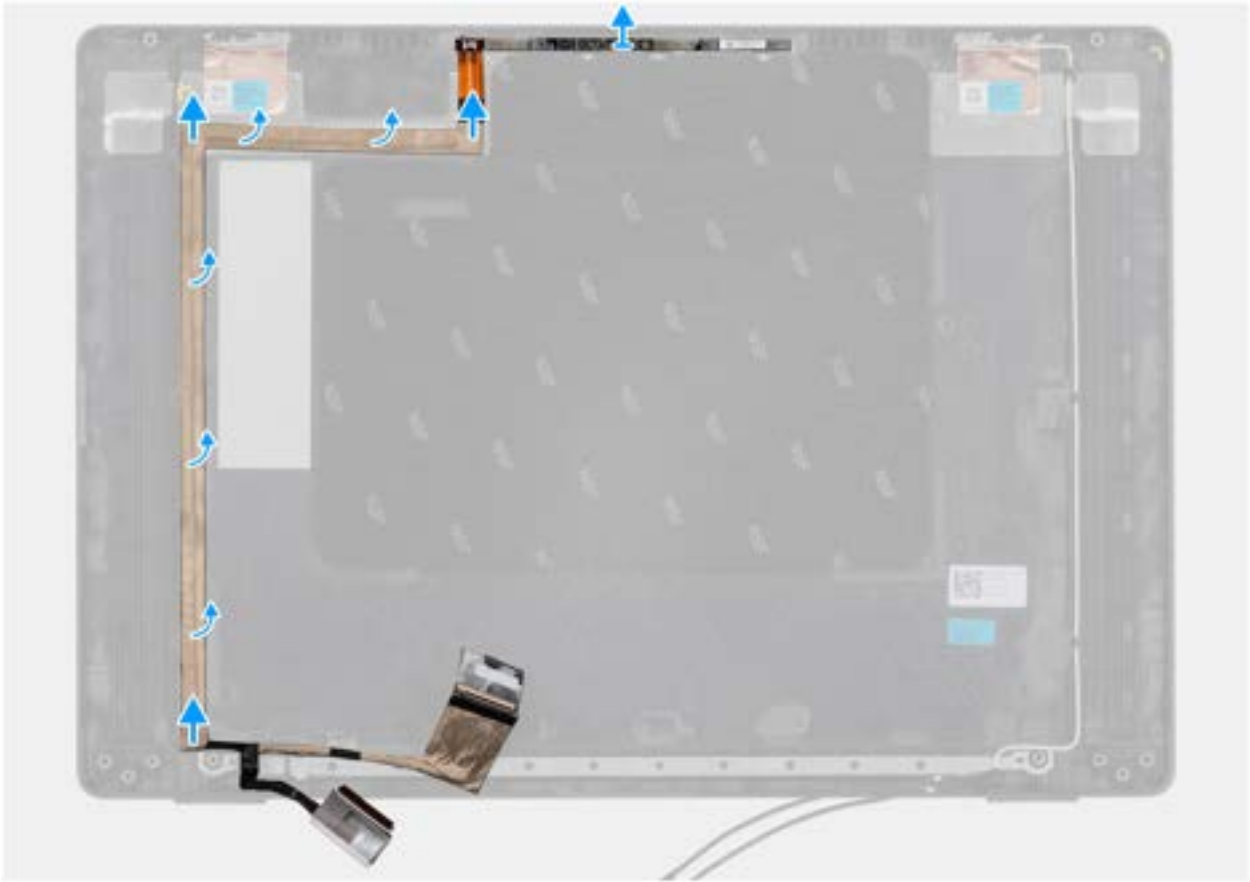
Afbeelding 94. Removing the eDP cable
