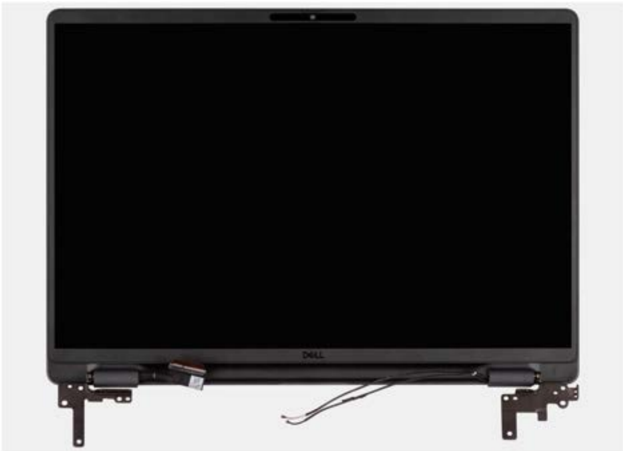
Afbeelding 74. Removing the display assembly
