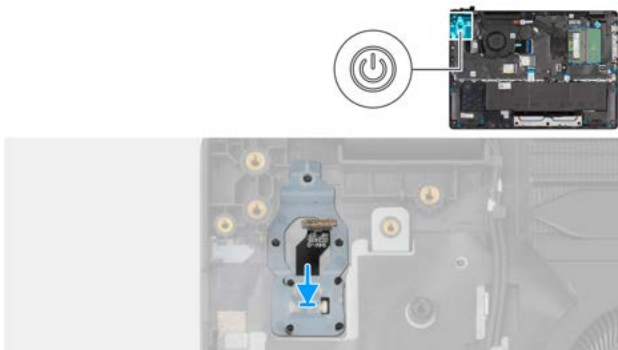
Afbeelding 45. Installing the power button with a fingerprint reader
