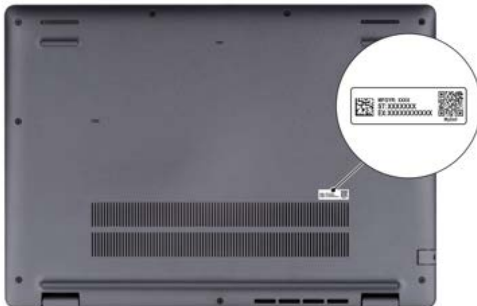
Afbeelding 6. Locatie van servicetag/express-servicecode
