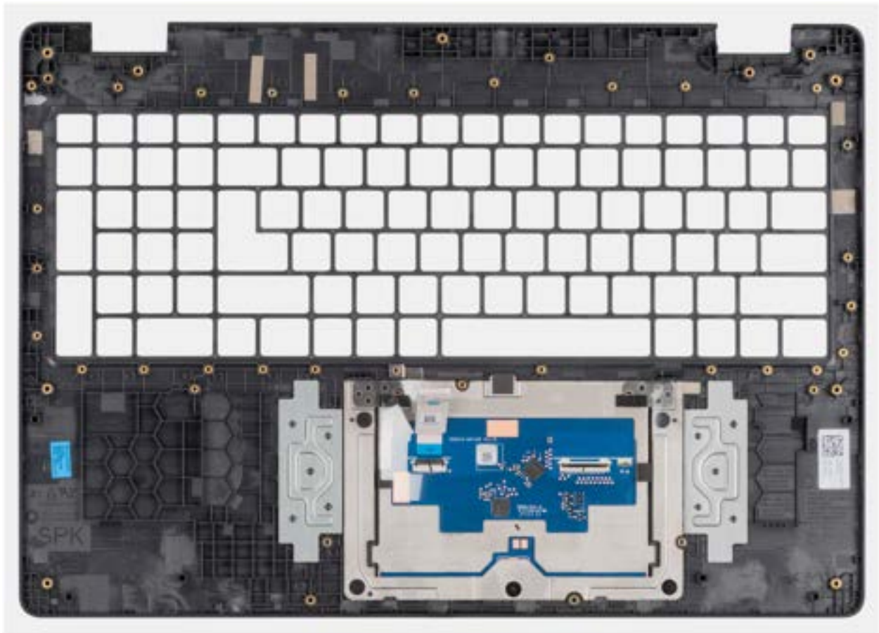
Afbeelding 71. Installing the palm-rest assembly
