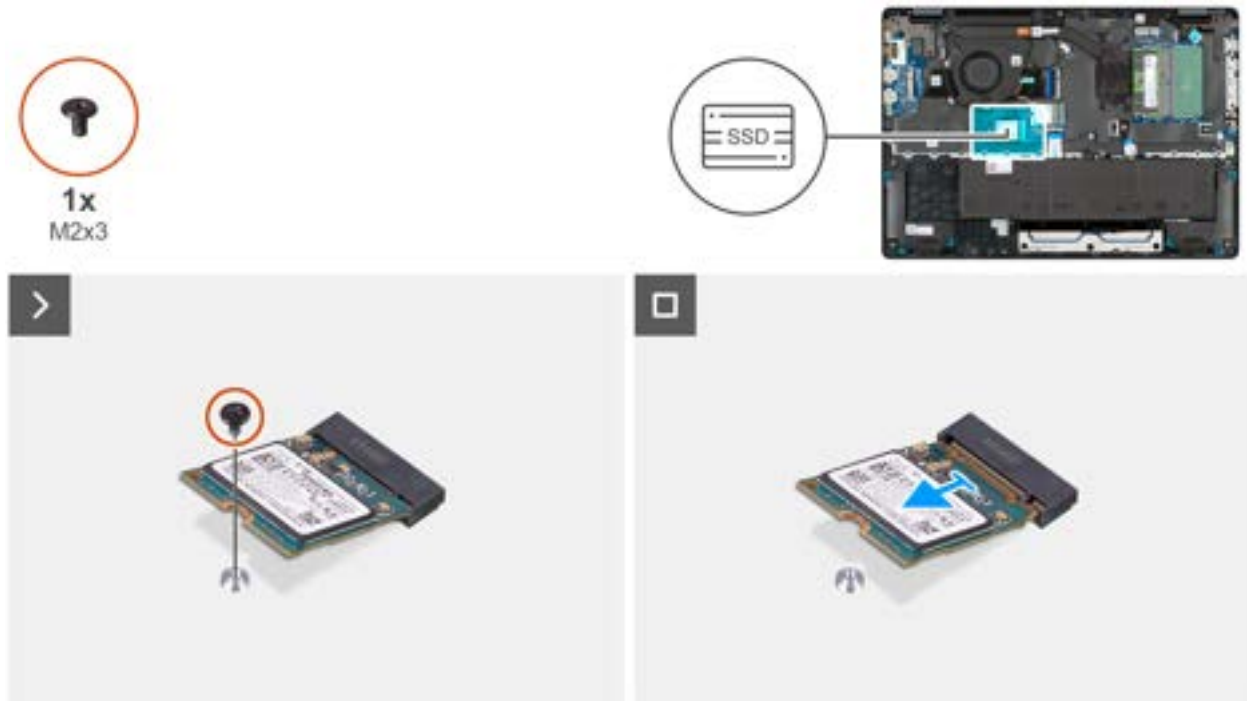
Afbeelding 23. Removing the SSD
