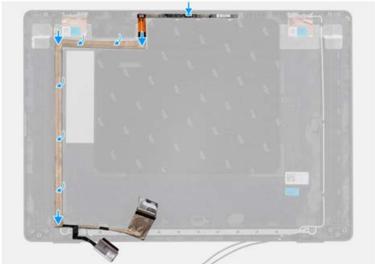
Afbeelding 95. Installing the eDP cable
