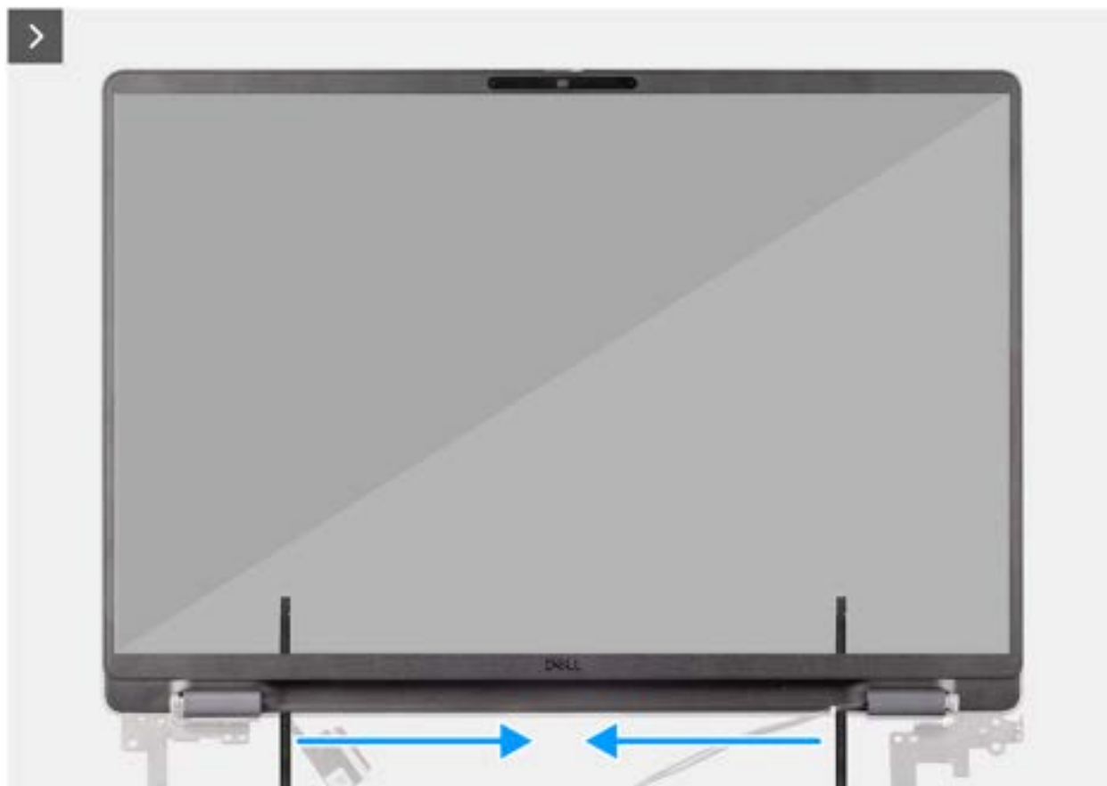
Afbeelding 78. Removing the display bezel
