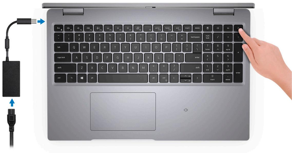
**ПРИМЕЧАНИЕ:** Для экономии заряда аккумулятора может перейти в энергосберегающий режим. Чтобы включить компьютер, подключите адаптер питания и нажмите кнопку питания.
